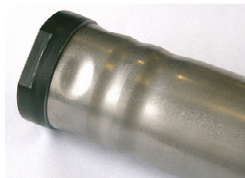
Bild 9: EMPT Fügung an einem LKW-Kotflügelhalter
