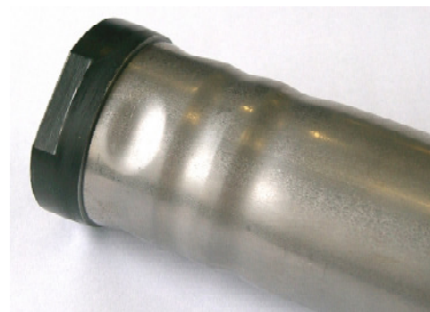
Bild 9: EMPT Fügung an einem LKW-Kotflügelhalter
