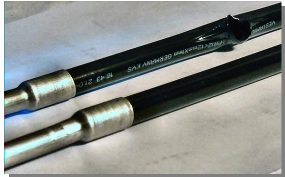
Bild 8: Druckfeste Verbindung eines Schlauches mit einem Stahlanschluss
