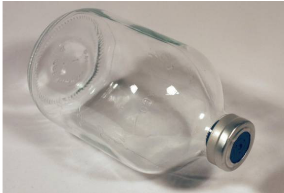
Bild 9: Vial-Medizinflasche mit EMPT gecrimpten Aluminiumdeckel
