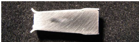
Bild 14: EMPT Schweißung der ferritisch-martensitischen Stahllegierung T91 für Atomkraft-Kernbrennstäbe (ø8mm)
