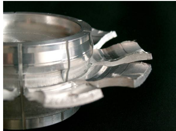
Bild 11: Erfolgreicher Schältest eines EMPT geschweißten Alu-Alu Druckbehälters
