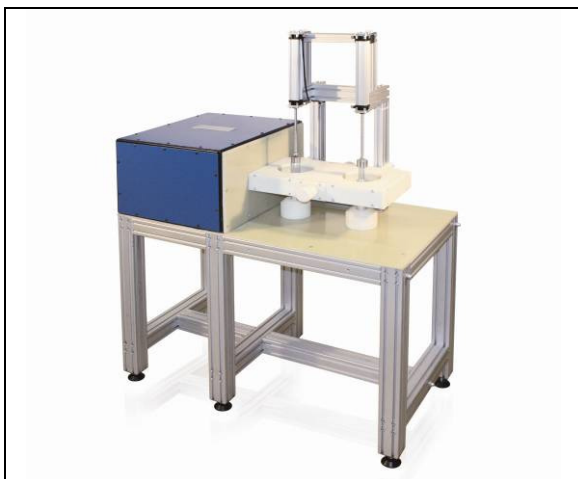
Bild 16: Von PSTproducts patentierte MJo Spule zum gleichzeitigen Fügen von zwei Werkstücken
