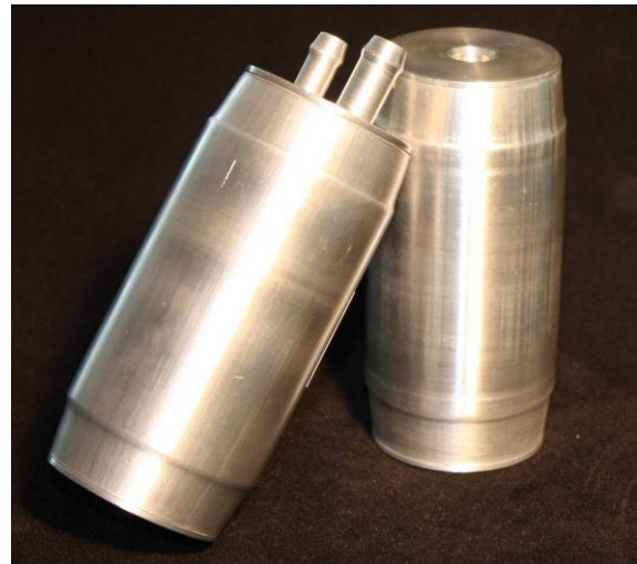
Bild 12: Kleine EMPT geschweißte Druckbehälter für den Automobilbau (ø50mm)
