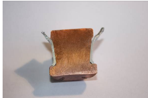
Bild 15: EMPT Schweißung einer Aluminium-Kupfer Mischverbindung (ø25mm)
