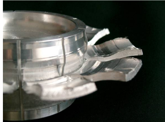
Bild 11: Erfolgreicher Schältest eines EMPT geschweißten Alu-Alu Druckbehälters
