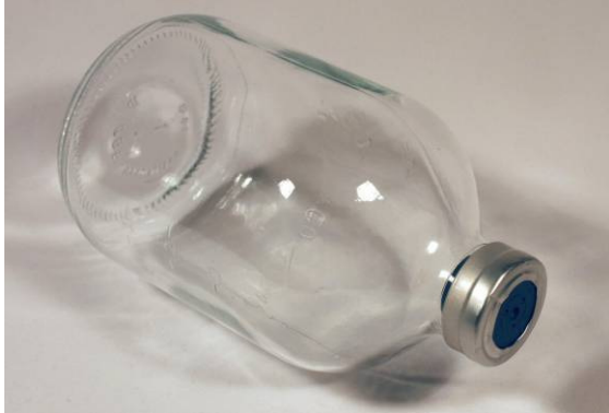
Bild 9: Vial-Medizinflasche mit EMPT gecrimpten Aluminiumdeckel
